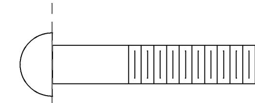
BHCS = Vis d'assemblage à tête ronde
